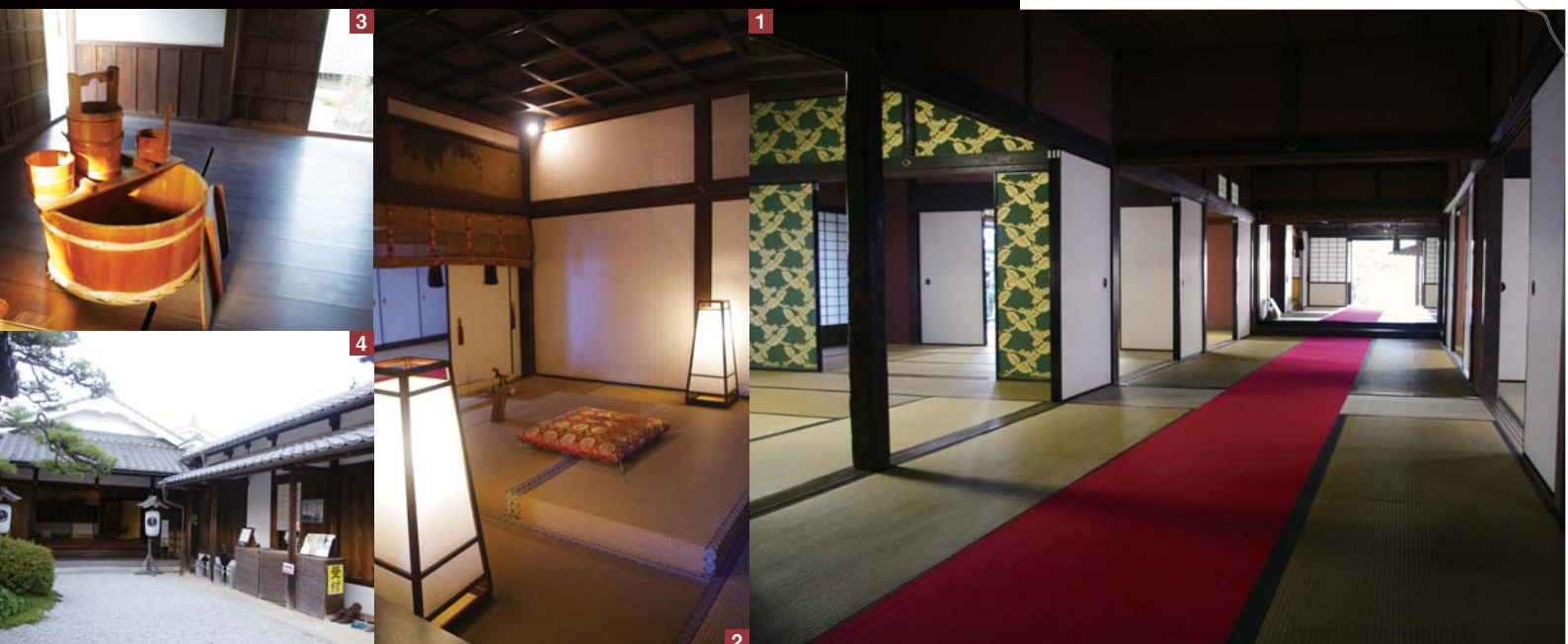
1 畳廊下の左右が個室。満室の時はこの廊下も部屋になる 2 上段の間 3 主客専用の湯殿。床には2°の傾斜があり湯が部屋中央の隙間から流れていくしくみ 4 人専用の玄関。馬と荷物は別の出入口がある
